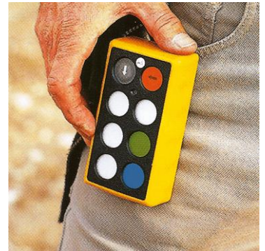
Funkfernsteuerung mit sicherer Zweihandbedienung
